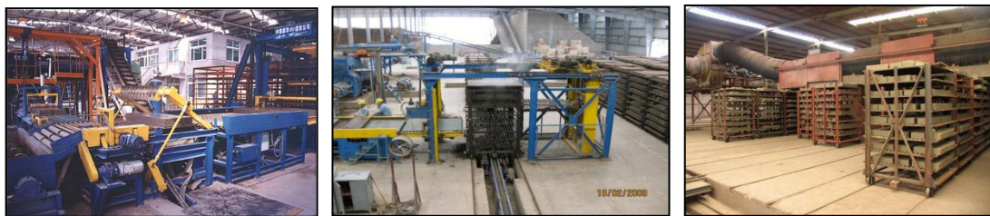
图 3 干燥车与托板连为一体的“上下架”系统
