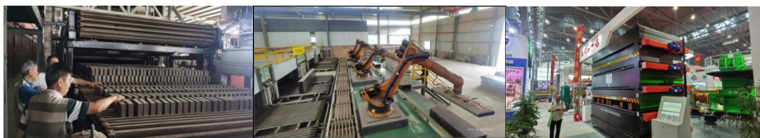
图9 其它形式的快速干燥系统 (左-链板式干燥窑、中-链式墙板干燥机、右-多层辊式干燥窑)
